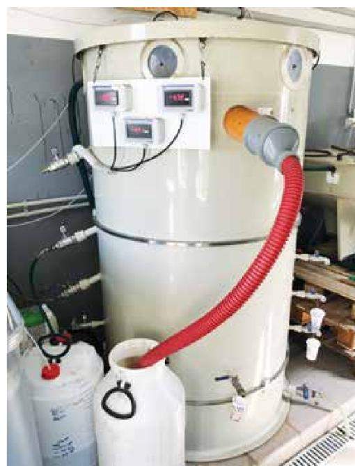
Foto 1: Poloprovozní reaktor pro nitrifikaci fugátu.
