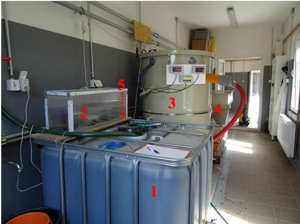
Obrázek 3: Fotografie poloprovozního nitrifikačního reaktoru pro zpracování fugátu
