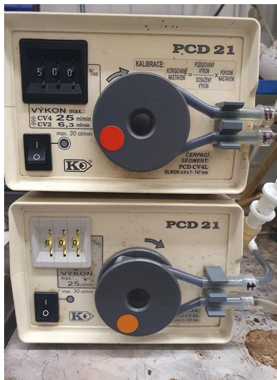
Obr. č. 4 Čerpadla zodpovědná za střídání fází
