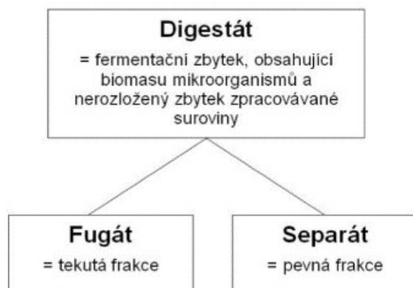
Obrazek 3: Separované složky digestátu
