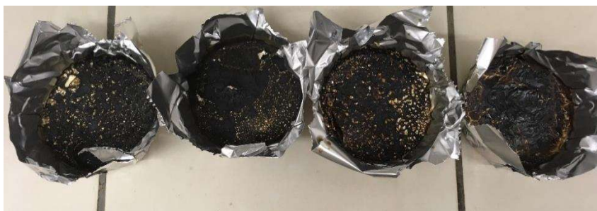
Obr. 13 Vzorky po 2 hod sušení v sušárně při 105°C (Vlastní zdroj).
