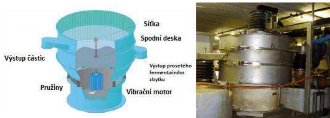
Obrázek č. 8: Vibrační síto (Drogs et al. 2015)
