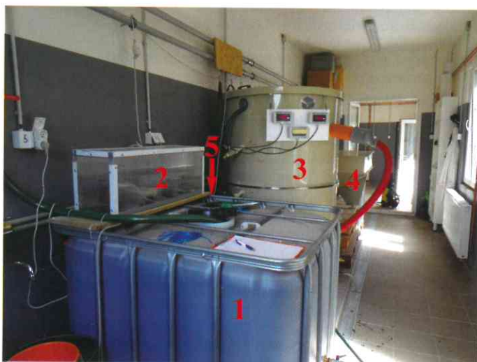
Obr. 1. Fotografie poloprovozního nitrifikačního reaktoru pro zpracování fugátu (1 – zásobník vstupního fugátu; 2 – čerpadla pro transport fugátu a dalších tekutin; 3 – vlastní nitrifikační reaktor; 4 – dosazovací nádrž; 5 – membránové dmychadlo)
